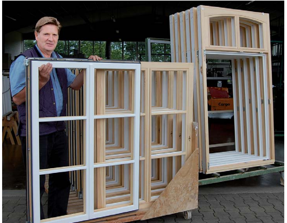
Alfred Seel, Inhaber der gleichnamigen Tischlerei in Lönningen, Landkreis Cloppenburg (Niedersachsen) mit einer Partie fertiger Fenster für ein 30 m langes niedersächsisches Hallenhaus. Der Clou: innen transparent beschichtete Kiefer, außen Accoya®, weiß lackiert.
