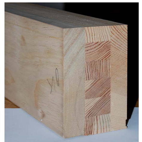
Kantel in 4,80 m Länge: Decklamelle im Außenbereich aus Accoya®-Holz, im Kern und innen heimische Hölzer
