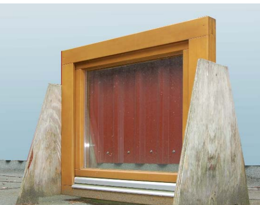
Accoya®-Musterfenster mit Induline-Beschichtung, frei bewittert, ohne konstruktiven Schutz: tadelloser Zustand auch der Eckverbindungen nach vier Jahren. Kein Aufquellen feststellbar.
