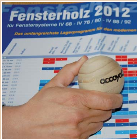
Der einfache Test: Accoya-Kugel eine Woche in einem Glas, gefüllt mit Wasser, lagern. Das Ergebnis: kaum Gewichtszunahme, da nur eine geringe Menge Wasser eindringt.
